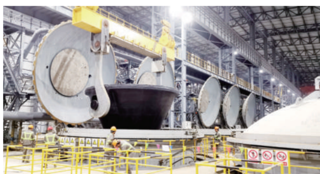
图为河钢产业升级及宣钢产能转移项目钢渣处理项目,采用中冶节能环保“熔融钢渣高效罐式有压热网处理技术与装备”和世界最大直径立式有压热网罐。
