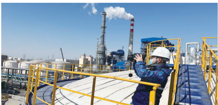
图为刘方在河北省沧州市监督帮扶工作中,爬上某化工企业储罐,使用红外热成像设备观察周边储罐无组织排放情况。南京市生态环境综合行政执法局供图
