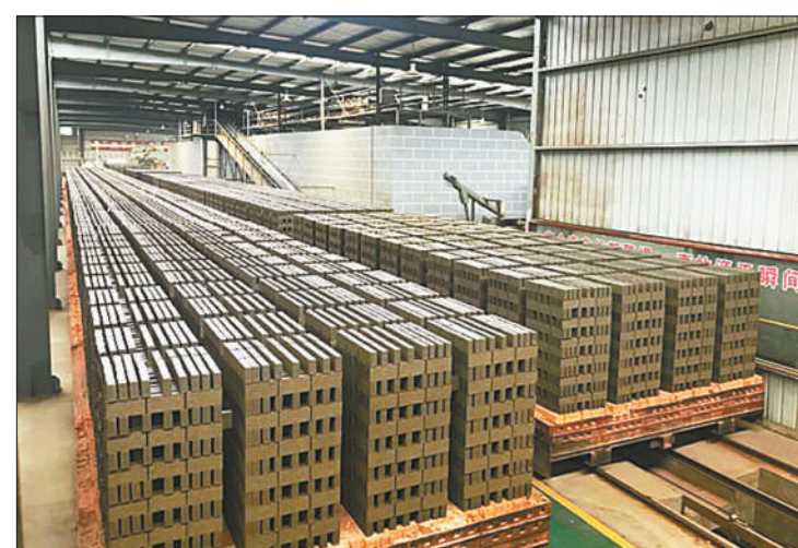
湖北省近日发布2021年度通过“禁实”工作验收乡镇名单,十堰市有12个乡镇通过验收。2021年,十堰市郧阳区大柳乡等12个乡镇共关停拆除粘土实心砖生产企业9家,新建建筑应用新型墙体材料比例达到100%。图为一家新型墙体企业生产的新型墙体。薛乐生 杨备家摄
