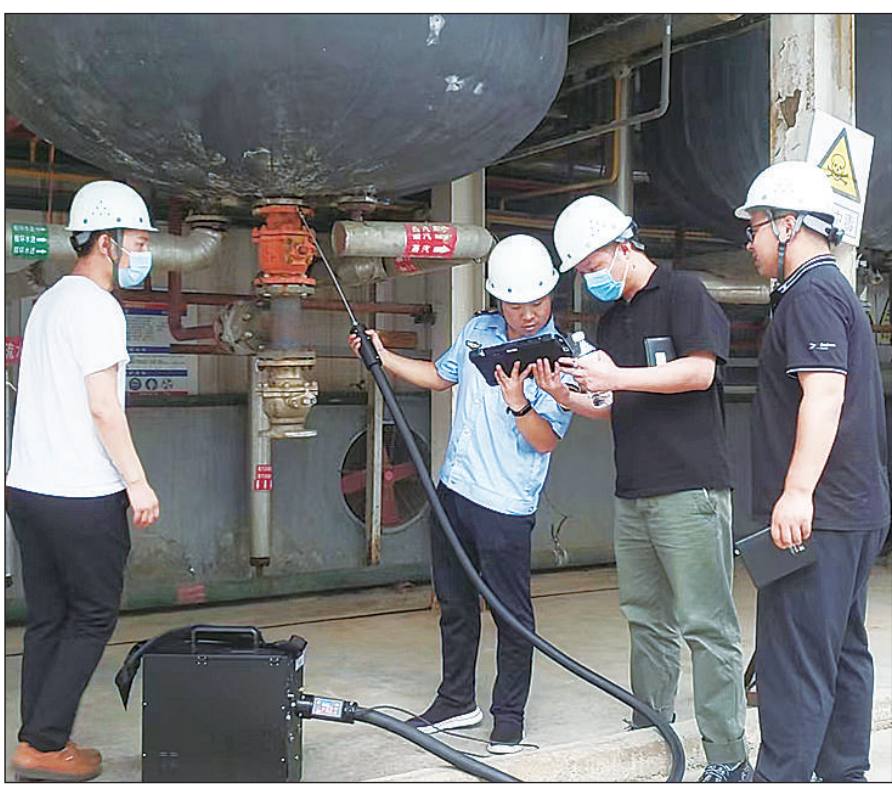
盛夏时分,骄阳似火,河南省鹤壁市生态环境局鹤山分局近日对辖区内重点排污单位开展全面检查。为保质保量完成任务,执法人员不惧烈日炙烤,一丝不苟地对企业生产车间、排放口等检测点位的各项数据进行收集。图为执法人员使用FID设备检测非甲烷总烃数据。王宏平摄
