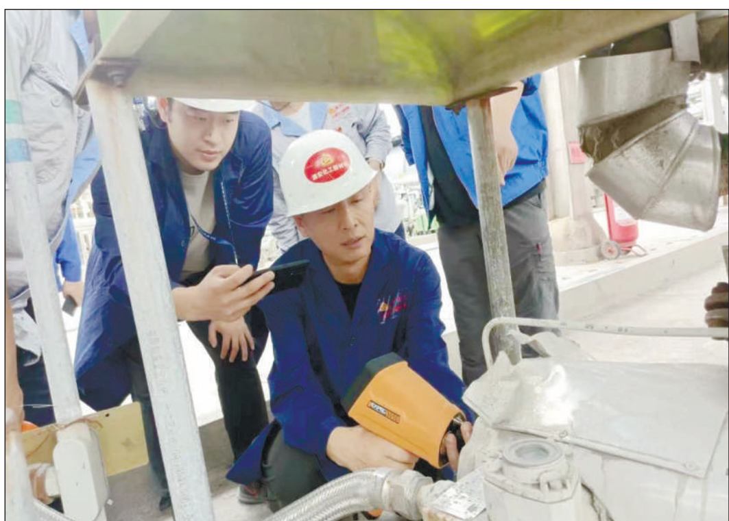
图为执法人员利用FID等执法辅助设备,核查企业各环节各点位VOCs泄漏情况。
