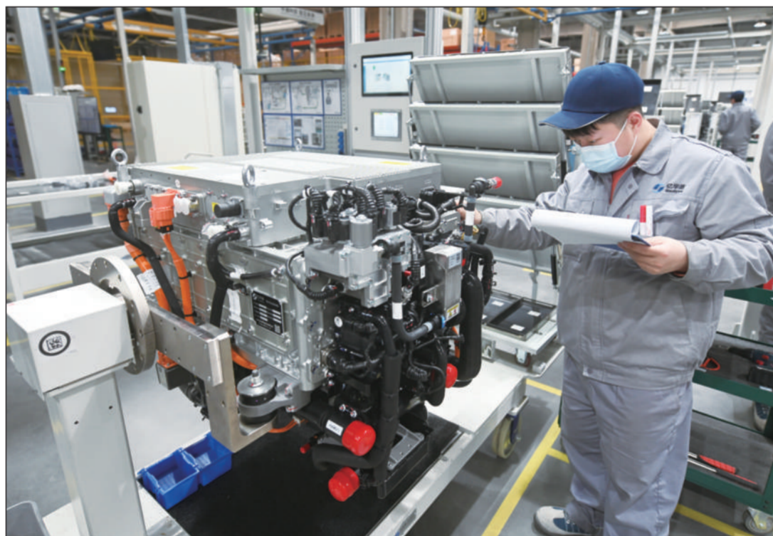
由亿华通自主开发的M180氢燃料电池发动机系统日前正式发布。这一产品具有大功率、高效率、智能化、无污染、动态响应等优势,综合性能达到国内同类产品领先水平,可搭载城际公交车、牵引车等车型。资料显示,截至2022年年底,全球燃料电池汽车保有量67488台,其中我国有12682台。图为位于北京大兴国际氢能示范区亿华通公司燃料电池发动机生产线。 本报记者邓佳摄
