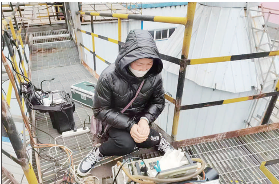
陕西省宝鸡市环境监测中心站近日启动了第一批锅炉大气污染物排放监测,共涉及燃煤、燃气、生物质锅炉23座,旨在全面掌握宝鸡市在用采暖锅炉污染物排放状况,督促锅炉使用单位增强环境保护意识,提升环境管理水平,为大气污染防治增添力量。图为工作人员爬到高处监测锅炉烟气排放情况。 侯佳明 吕建亮摄
