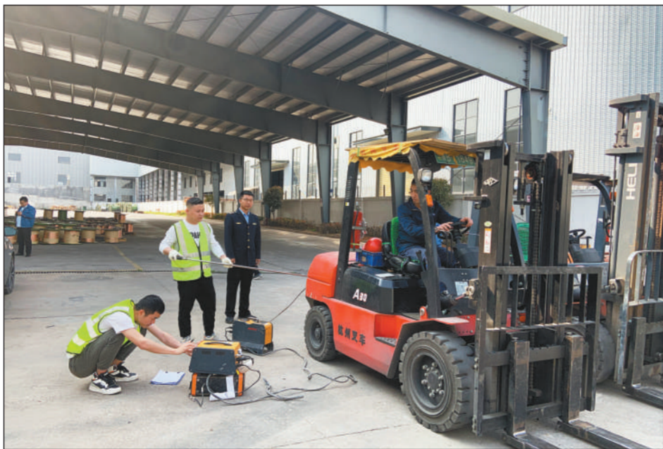
江西省赣州市生态环境局赣州经济技术开发区分局近期组织第三方对全区700余台在用非道路移动机械开展尾气排放监督性抽测专项行动。图为工作人员在对非道路移动机械进行尾气检测。 丁叶娥摄
