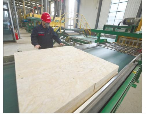
西省汉中市勉县 不断加大产业结 构调整力度,积 极践行循环发展 理念。图为当地 企业陕西华晟永 利保温材料科技 有限公司利用钢 铁厂高炉熔渣制 备无机纤维材料 技术生产岩棉产
