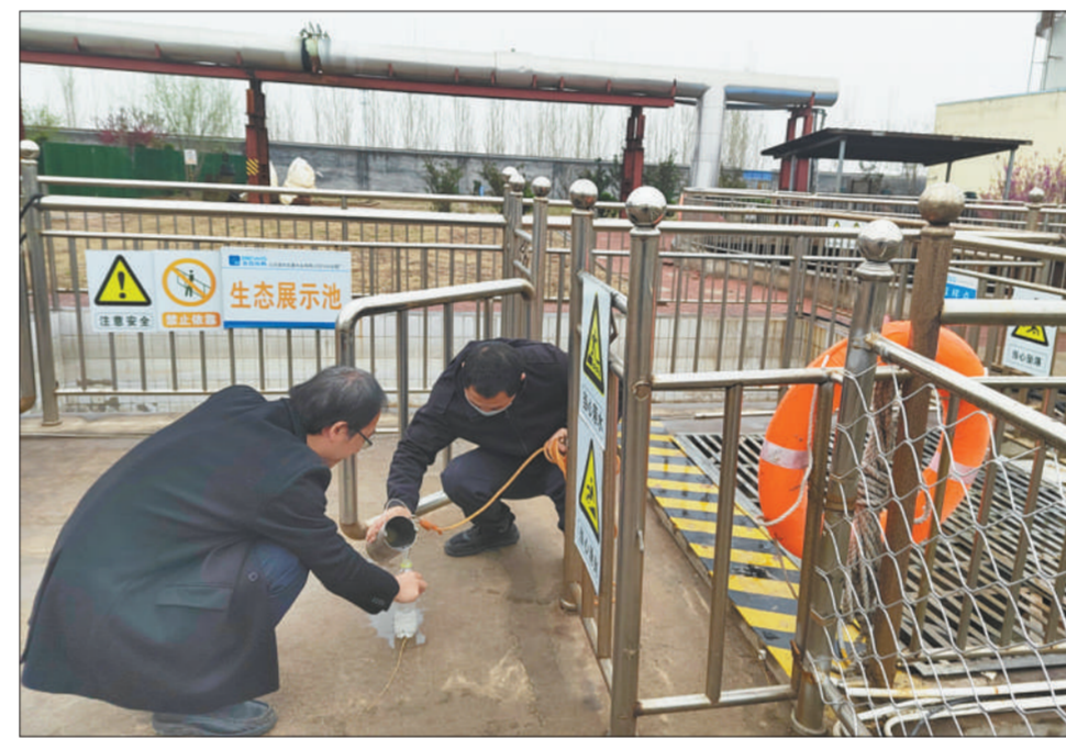
山东省潍坊市生态环境局昌乐分局近期加大降雨后河道巡查、污水处理厂采样检测频次,结合自动监测设备等科技手段,重点查看河流水质以及管网、溢流口的排水状况,确保河道水质稳定达标。图为监测人员在河流沿岸污水处理厂现场采样监测,掌握出水总氮浓度。朱广帅 董若义摄
