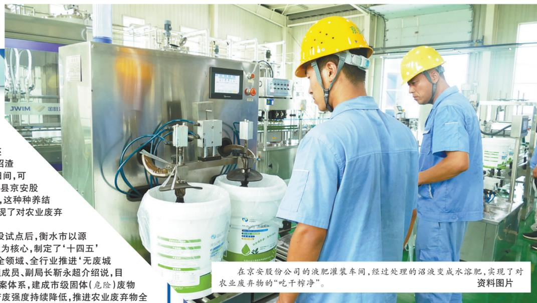
在京安股份公司的化肥灌装车间，经过处理的沼液变成水溶肥，实现了对农业废弃物的“吃干榨净”。
