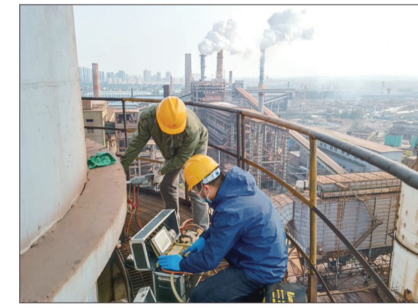
江西省新余生态环境监测中心监测人员近日深入重点排污企业生产现场,完成废气中颗粒物、二氧化硫、氮氧化物等指标的采样工作。截至目前,江西省新余生态环境监测中心已基本完成辖区62家重点排污单位的监测任务。 颜志高 敖磊文/摄
