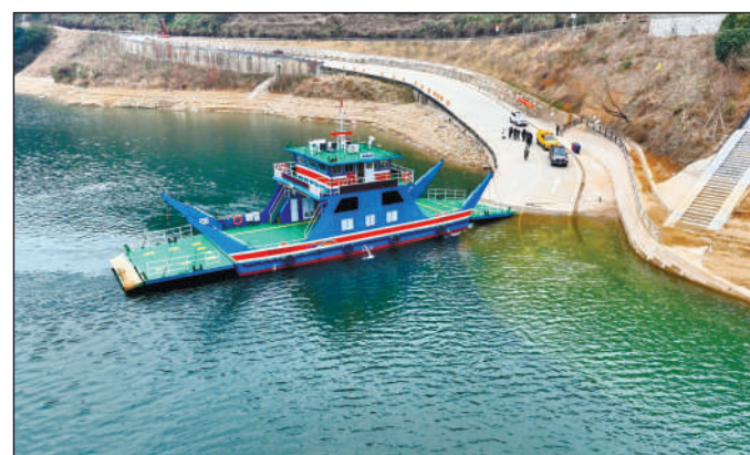
春节期间,浙江省首艘纯电6车客渡船——“浙景电0001”在丽水市景宁县渤海镇金头渡渡口正式投运。春运期间日均完成渡运量200人次,渡运车辆60辆次。该船采用锂电池纯电动推进,与传统燃油动力船舶相比,每年可减少燃油用量约25吨,减少碳排放约68吨。 吴彬彬 董浩摄影报道
