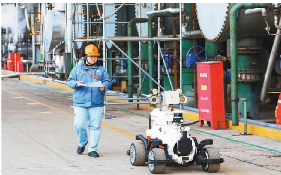
一款用于检测石化装置气体泄漏的新型巡检机器人近日在江苏省南京扬子石化现场进行调试和试点运行。这款机器人搭载声学成像设备,可利用声音查找泄漏点,将气体光谱成像与热成像相结合,及时发现机泵运行异常情况。图为机器人在炼油厂试运行。
