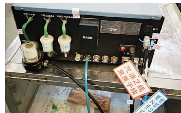
图为已完成明管明线改造的检验仪器。何闪闪供图
