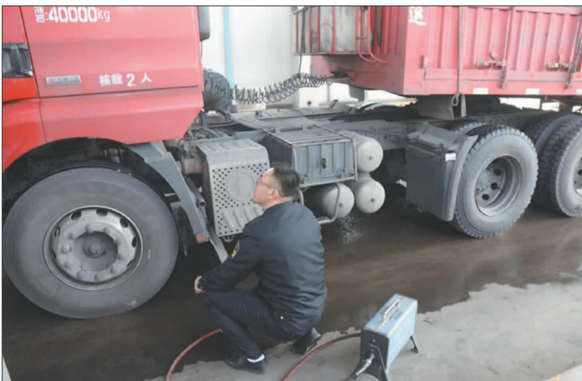
为强化移动源污染防治,近日,河北省石家庄市机动车排污管理中心检测人员采用路检路查和入户抽查的方式,对重型货车尾气排放情况进行监督抽测,严防私自改装尾气处理装置、破坏车载自动诊断系统等行为的发生。 郭运洲 魏宗敏摄影报道
